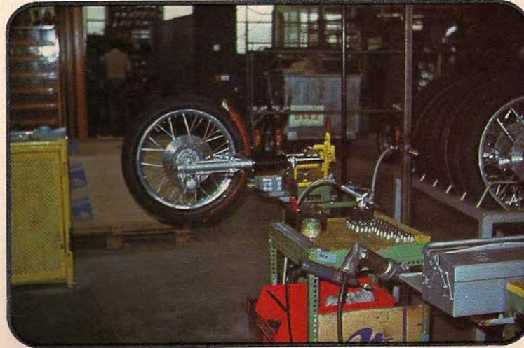
Aquí se colocan las horquillas, guardabarros y frenos de la rueda delantera.
